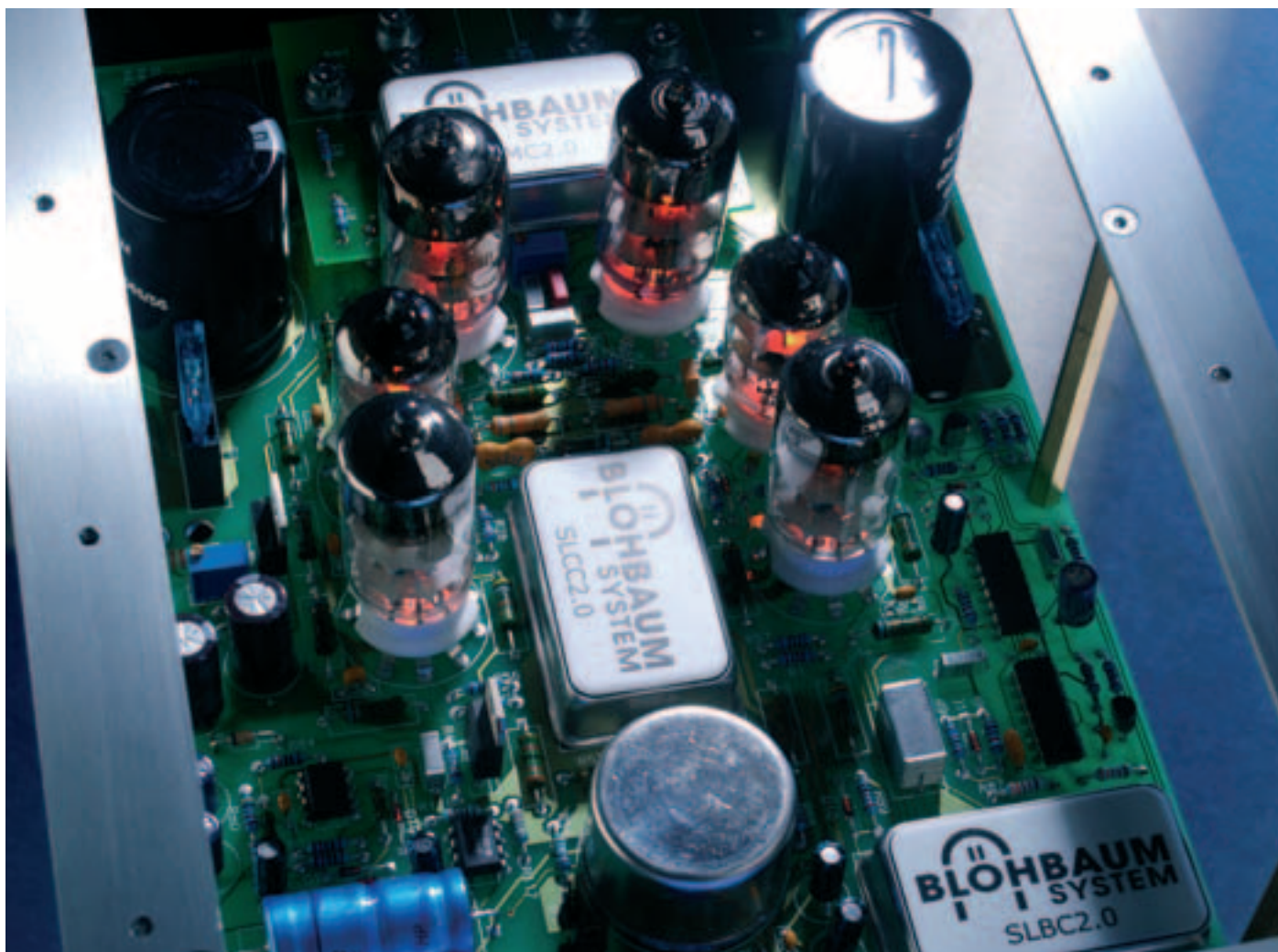
Gegen Spionage: Entscheidende Bauteile vergoss Entwickler Blöhbaum in „Abschirm“-Modulen. Das untere und obere kontrolliert Bias-Potentiale, das mittlere Anodenspannungen.
