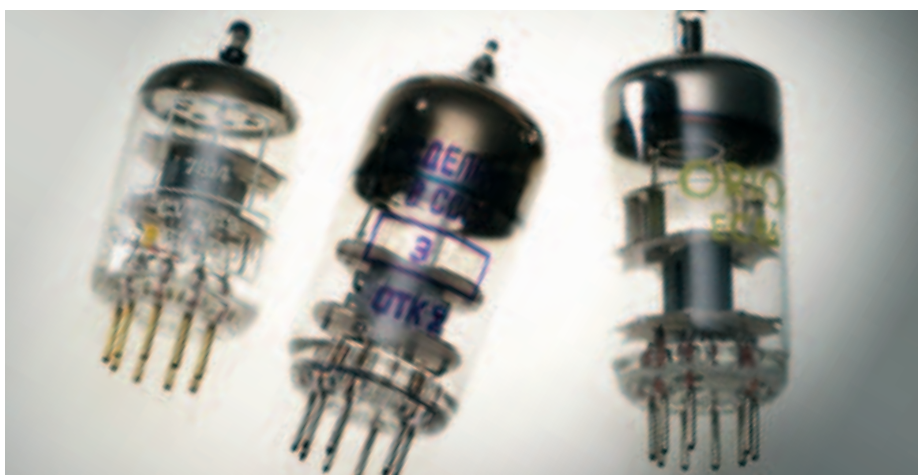
Selten steile Typen: Die russische 6S3P-EV (Mitte) kam nur beim Radar zum Einsatz, die CV 6189 (links) diente beim englischen Militär. Einzig die EC 86 gab's zum (UHF-TV-)Hausgebrauch.
